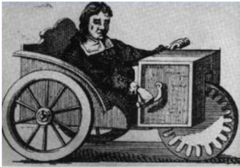
Stephen Farfler era paraplégico e em 1655, na Alemanha, construiu uma cadeira de rodas para se locomover. Era feita em madeira, com duas rodas atrás e uma na frente, acionada por duas manivelas giratórias.
